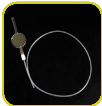
Cuvette for CD Titration
